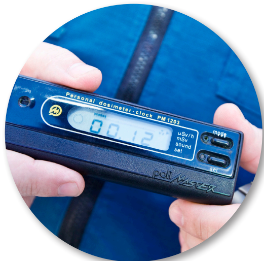
Allir sem vinna með geislavirk efni verða að hafa geislaæli á sér. Hann sýnir hvað þeir verða fyrir mikilli geislun á tilteknum tíma.
